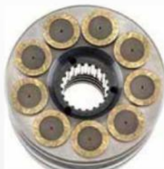
使用不能充分保护柱塞滑履的液压油在T6H20C泵试验结束时的柱塞滑履外观。请注意，其滑履发生退色，并且在每个滑履上都有广布的划痕。
