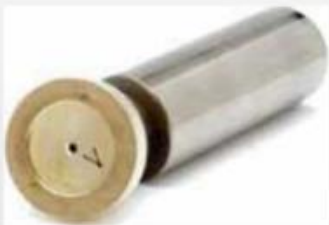
湿式阶段试验结束时的柱塞外观（在测试时间608小时时）。柱塞失重在测试边界值之内。
